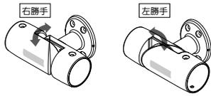
※使用時に手すり棒が急落下しない回転の硬さに設定しています。取付け時に回転させる場合には両側に手すり棒を差込んで回転させてください。
